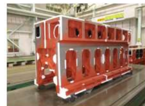
列型シリンダブロック FCD500 / ～20,000kg
