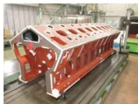
V型シリンダブロック FCD500 / ～25,000kg
