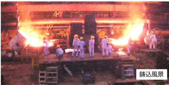
V型シリンダブロック FCD500 / ～25,000kg
